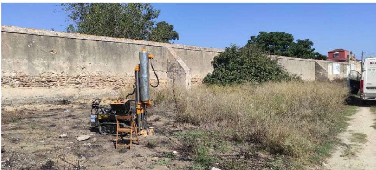
Emplazamiento del ensayo penetrométrico DPSH reseñado como P-4.
