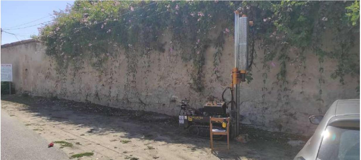
Emplazamiento del ensayo penetrométrico DPSH reseñado como P-5.
